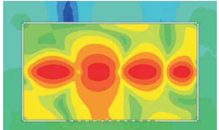
Bild 4: Elektromagnetische Feldverteilung in und um der Umgebung des Gehäuses.
