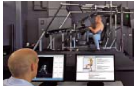
Versuchsaufbau mit Mock-up für die Ein-/Ausstiegsbewegung bei BMW
